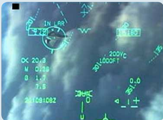
(version militaire de HUD : HUD version: FA-18 HUD de FA18 pendant un combat aérien) Source: Wikipedia
